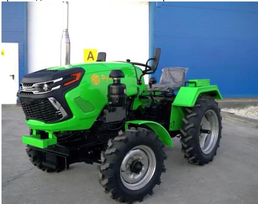
Применяя разнообразное навесное оборудование, минитрактор способен пахать, культивировать и бороновать землю, сажать, окучивать и выкапывать корнеплоды, косить и убирать траву, а также перевозить грузы **массой до 1,5 тонны**.
